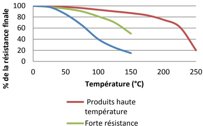
*"Dureté à chaud" Couple de rupture sur des boulons M10 en acier zingué selon la norme ISO 10964. Polymérisé à 23° pendant 24 heures puis conditionné pendant 30 minutes à des températures d'essai.*
