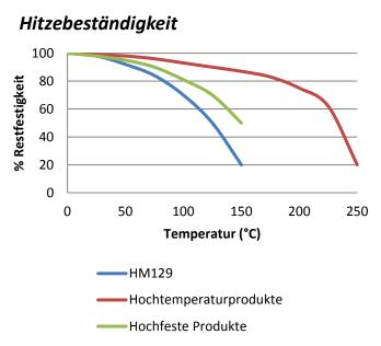
"Hitzebeständige" Losbrechfestigkeit wurde bei verzinkten Schrauben M10 gemäß ISO 10964 geprüft. Aushärtung bei 23°C über 24 Stunden. Vor den Testversuchen wurden die Teile über 30 Minuten auf der Testtemperatur gehalten.
