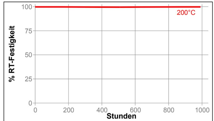
**Alterung durch Umgebungseinflüsse - Auswirkungen auf Materialeigenschaften**Gehärtet für 21 Tage bei 23±2 °C / 60±5% RH, Schichtstärke 2 mm
