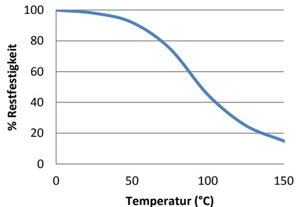
„Hitzebeständige“ Scherfestigkeitsversuche wurden auf Glas auf Weichstahl Klebeverbindungen durchgeführt. Vor den Testversuchen wurden die Teile über 30 Minuten auf der Testtemperatur gehalten. UV648 kann bei geringen Belastungen kurzzeitig auch höheren Temperaturen ausgesetzt werden (z.B. bei Einbrennlack- oder Schwall-Löt-Verfahren). Niedrigste Temperatur bei Endfestigkeit: -55°C (abhängig von den verwendeten Materialien).
