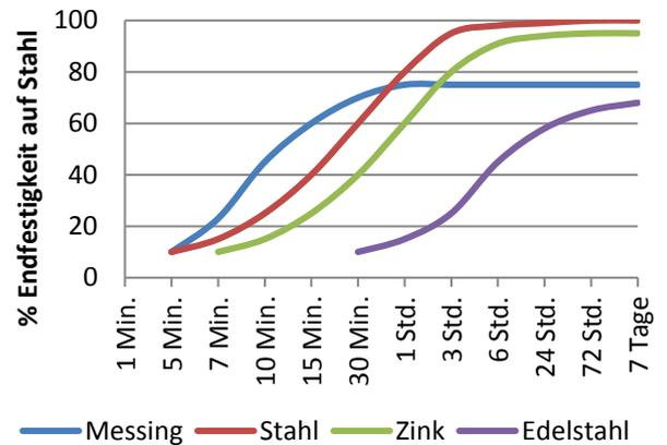
\* Dies sind typische Werte auf Stahloberflächen bei 23°C. Kupfer und Kupferlegierungen beschleunigen die Aushärtung, inaktive Oberflächen (wie rostfreier Stahl oder Zink) sowie niedrige Temperaturen und große Spalte verlängern die Aushärtezeit. Um die Aushärtezeit zu verringern, kann der Oberflächenaktivator Permabond A905 verwendet oder die Verklebung erwärmt werden.
