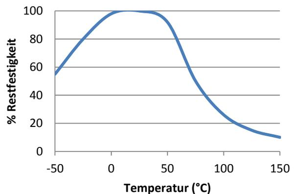
„Hitzeständige“ Scherfestigkeitsversuche wurden auf Weichstahl durchgeführt. Aushärtung bei Raumtemperatur über 24 Stunden. Vor den Testversuchen wurden die Teile über 30 Minuten auf der Testtemperatur gehalten.
