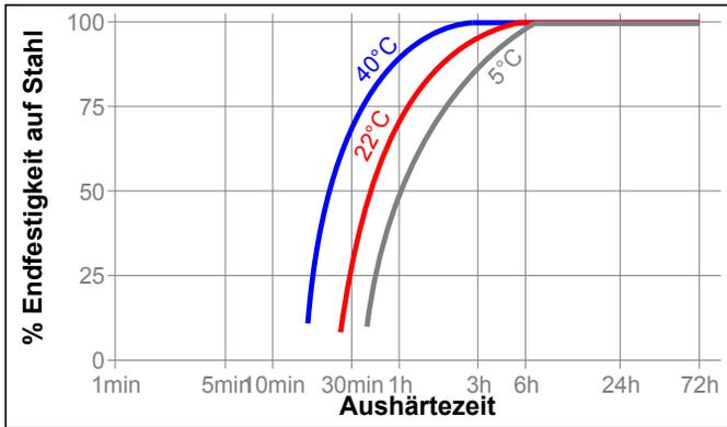
**Aushärtegeschwindigkeit in Abhängigkeit vom Aktivator**
