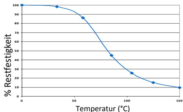
MT382 kann bei geringen Belastungen kurzzeitig auch höheren Temperaturen ausgesetzt werden (z.B. bei Einbrennlack- oder Schwall-Löt-Verfahren). Niedrigste Temperatur bei Endfestigkeit: -40°C (abhängig von den verwendeten Materialien).
