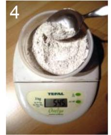
Für ein optimales Resultat, rechnen Sie die 7 Teile Pulver auf das Gesamtgewicht der Flüssigkomponente (Acrystal Aqua + Pigmente + Thixotropierer).
