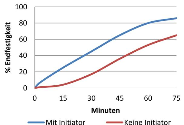
Die grafische Darstellung zeigt den typischen Aufbau der Festigkeit bei der Verklebung von Probestücken, welche bei 23°C verklebt wurden. Wird die Temperatur um 8°C erhöht, halbiert sich die Aushärzeit. Niedrigere Temperaturen haben eine langsamere Aushärtung zur Folge.
