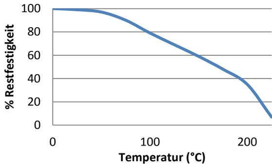
„Hitzebeständige“ Scherfestigkeitsversuche wurden auf Weichstahl durchgeführt. Aushärtung bei Raumtemperatur vollständig. Vor den Testversuchen wurden die Teile über 30 Minuten auf der Testtemperatur gehalten.
