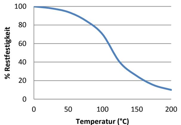
„Hitzebeständige“ Scherfestigkeitsversuche wurden auf Glas auf Weichstahl Klebeverbindungen durchgeführt. Vor den Testversuchen wurden die Teile über 30 Minuten auf der Testtemperatur gehalten. UV681 kann bei geringen Belastungen kurzzeitig auch höheren Temperaturen ausgesetzt werden (z.B. bei Einbrennlack- oder Schwall-Löt-Verfahren). Niedrigste Temperatur bei Endfestigkeit: -55°C (abhängig von den verwendeten Materialien).
