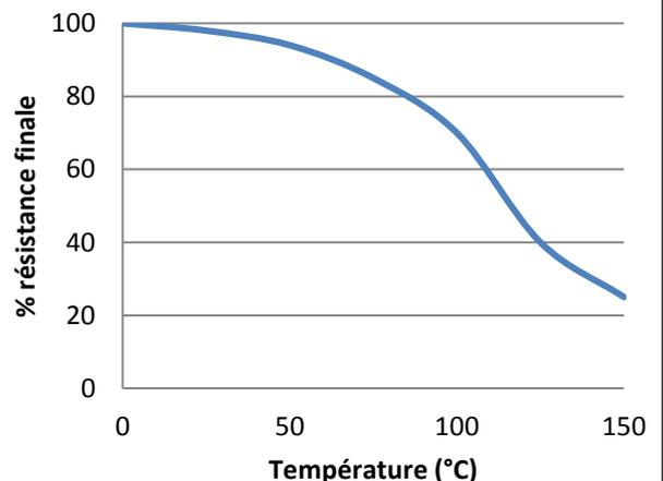
Essais de cisaillement à différentes températures réalisés sur des assemblages verre sur acier doux. Les échantillons sont entièrement polymérisés avant d'être mis en température pendant 30 minutes avant réalisation des essais.
