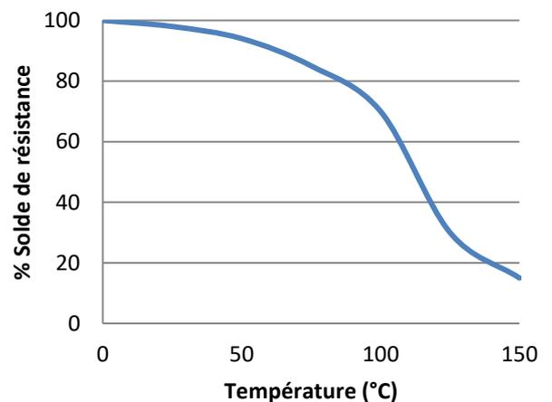
Essais en cisaillement à chaud réalisés sur des assemblages verre sur acier doux. Les échantillons sont entièrement polymérisés avant d'être mis en température pendant 30 minutes avant réalisation des essais.
