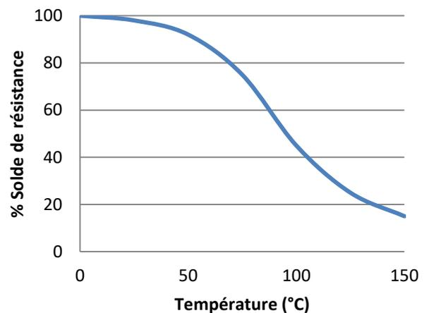
Essais en cisaillement à chaud réalisés sur des assemblages verre sur acier doux. Les échantillons sont entièrement polymérisés avant d'être mis en température pendant 30 minutes avant réalisation des essais. UV648 peut être soumis sous faible contrainte mécanique à des températures plus élevées. Par exemple Thermo-laquage, soudage. Température minimale après polymérisation: -55°C (-65°F) dépendant des matériaux.
