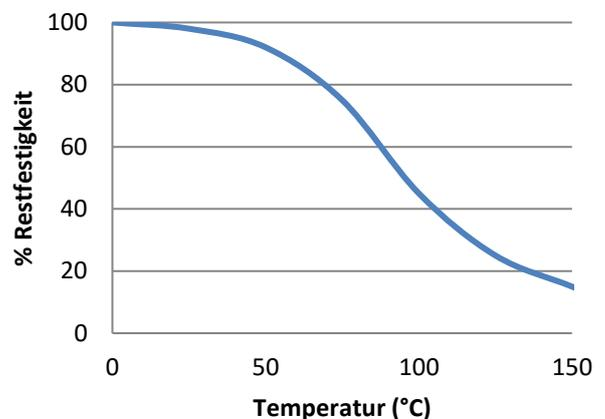
Weichstahl Klebeverbindungen durchgeführt. Vor den Testversuchen wurden die Teile über 30 Minuten auf der Testtemperatur gehalten. UV630 kann bei geringen Belastungen kurzzeitig auch höheren Temperaturen ausgesetzt werden (z.B. bei Einbrennlack- oder Schwall-Löt-Verfahren). Niedrigste Temperatur bei Endfestigkeit: -55°C (abhängig von den verwendeten Materialien).
