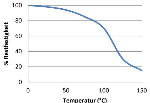
„Hitzebeständige“ Scherfestigkeitsversuche wurden auf Glas auf Weichstahl Klebeverbindungen durchgeführt. Vor den Testversuchen wurden die Teile über 30 Minuten auf der Testtemperatur gehalten. UV610 kann bei geringen Belastungen kurzzeitig auch höheren Temperaturen ausgesetzt werden (z.B. bei Einbrennlack- oder Schwall-Löt-Verfahren). Niedrigste Temperatur bei Endfestigkeit: -55°C (abhängig von den verwendeten Materialien).
