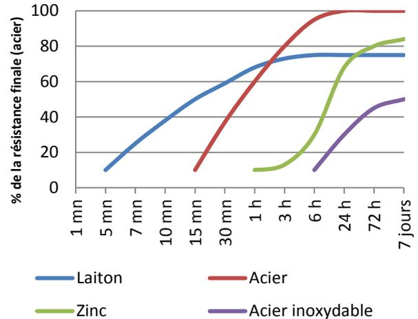
Ces données de polymérisation sont typiques à 23°C. Le cuivre et ses alliages accélèrent la polymérisation tandis que les surfaces oxydées ou passivées, tel l'acier inoxydable, la ralentissent. Une température basse ou un jeu important ralentiront aussi la polymérisation. Pour réduire le temps de polymérisation nous préconisons l'utilisation de notre activateur Permabond A905 ou de chauffer l'assemblage dans la mesure du possible.
