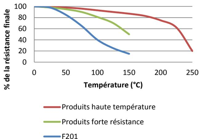
"Dureté à chaud" Couple de rupture sur des boulons M10 en acier zingué selon la norme ISO 10964. Polymérisé à 23° pendant 24 heures puis conditionné pendant 30 minutes à des températures d'essai.
