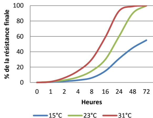
Ce graphique montre un développement typique de la résistance des composants collés. Une augmentation de température de 8° réduira de moitié le temps de polymérisation. Plus les températures sont basses, plus le temps de polymérisation est long.
