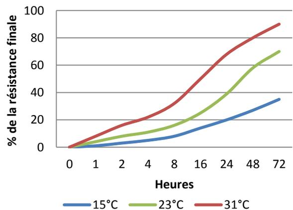
Ce graphique montre un développement typique de la résistance des composants collés. Une augmentation de la température de 8° réduira de moitié le temps de polymérisation. Plus les températures sont basses, plus le durcissement est lent.
