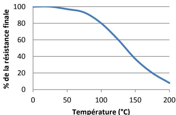
Essais de cisaillement en température réalisés sur de l'acier doux. Les échantillons sont entièrement polymérisés avant d'être mis en température pendant 30 minutes avant réalisation des essais.
