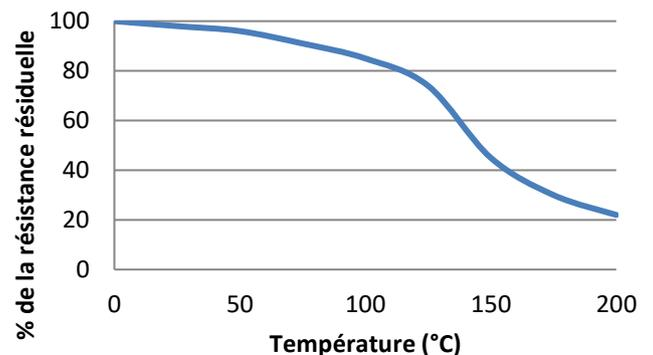
Tests de résistance au cisaillement à des températures élevées sur acier doux. Polymérisation complète à température ambiante, puis mise en température durant 30 minutes avant réalisation des essais.
