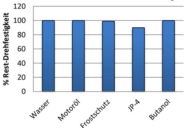
Dieses Produkt ist nicht geeignet für Verbindungen, die in direktem Kontakt mit Dampf oder reinem Sauerstoff stehen. Ein längerer Kontakt mit starken Säuren, Laugen oder stark polaren Lösungsmitteln ist zu vermeiden. Warnung: Das Produkt könnte u.U. einige Thermoplaste angreifen. Dem Anwender wird daher empfohlen, vor Gebrauch eine entsprechende Verträglichkeitsprüfung durchzuführen.
