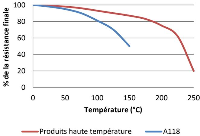
“Dureté à chaud” Couple de rupture sur des boulons M10 en acier zingué selon la norme ISO 10964. Polymérisé à 23° pendant 24 heures puis conditionné pendant 30 minutes à des températures d'essai.
