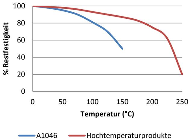
*“Hitzebeständige” Losbrechfestigkeit wurde bei verzinkten Schrauben M10 gemäß ISO 10964 geprüft. Aushärtung bei 23°C über 24 Stunden. Vor den Testversuchen wurden die Teile über 30 Minuten auf der Testtemperatur gehalten.*
