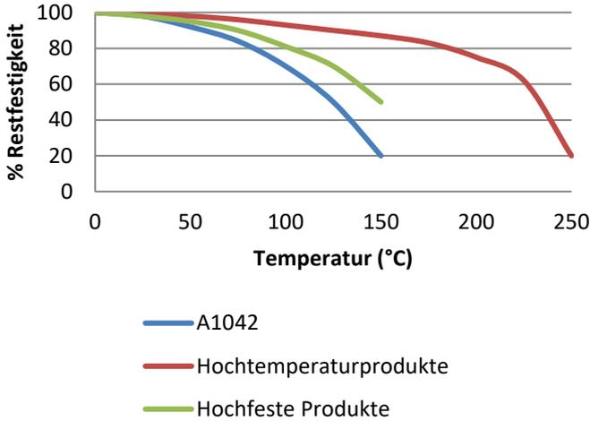
*"Hitzebeständige" Losbruchfestigkeit wurde bei verzinkten Schrauben M10 gemäß ISO 10964 geprüft. Aushärtung bei 23°C über 24 Stunden. Vor den Testversuchen wurden die Teile über 30 Minuten auf der Testtemperatur gehalten.*
