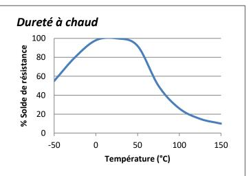
Polymérisation de 24h à température ambiante, puis mise en température durant 30 minutes avant réalisation des essais.
