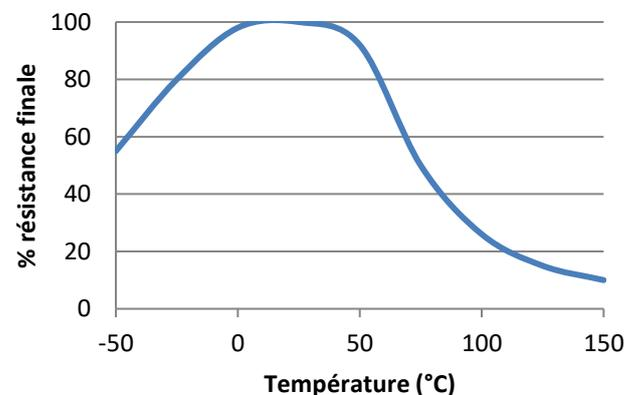
Essais de cisaillement à différentes températures réalisés sur de l'acier doux. Polymérisation complète à température ambiante, puis mise en température durant 30 minutes avant réalisation des essais.
