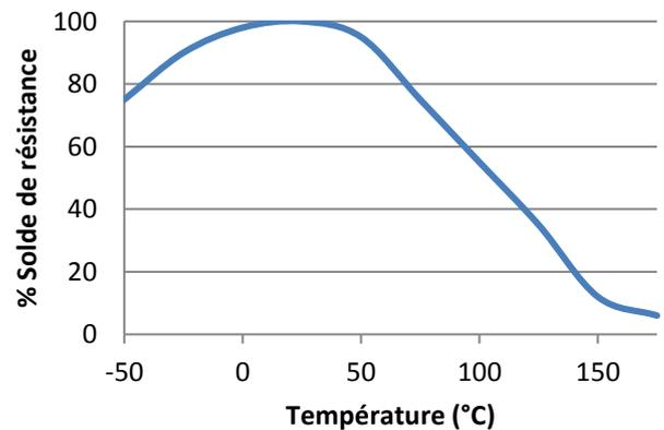
Essais de cisaillement en température réalisés sur l'acier doux. Polymérisation de 24h à température ambiante, puis mise en température durant 30 minutes avant réalisation des essais.
