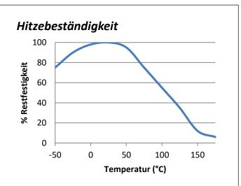
"Hitzebeständige" Scherfestigkeitsversuche wurden auf Weichstahl durchgeführt. Aushärtung bei Raumtemperatur über 24 Stunden. Vor den Testversuchen wurden die Teile über 30 Minuten auf der Testtemperatur aehalten.
