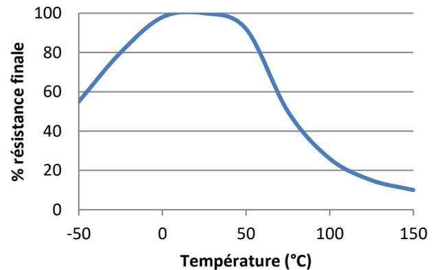
Essais de cisaillement en température réalisés sur acier doux. Polymérisation de 24h à température ambiante, puis mise en température pendant 30 minutes avant réalisation des essais.
