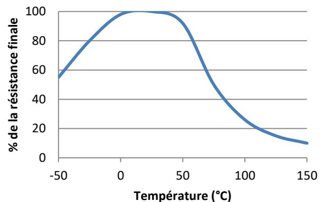
Essais de cisaillement en température réalisés sur de l'acier doux. Polymérisation de 24h à température ambiante, puis mise en température durant 30 minutes avant réalisation des essais.
