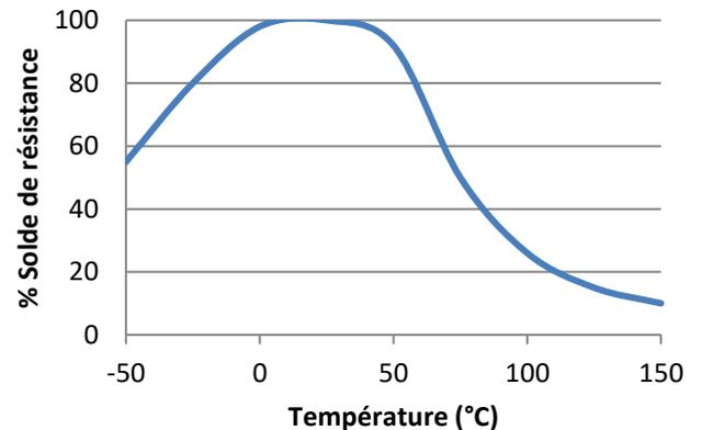
Essais de cisaillement en température réalisés sur l'acier doux. Polymérisation de 24h à température ambiante, puis mise en température durant 30 minutes avant réalisation des essais.
