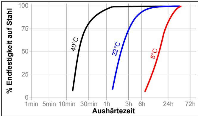
**Aushärtegeschwindigkeit in Abhängigkeit vom Aktivator**
