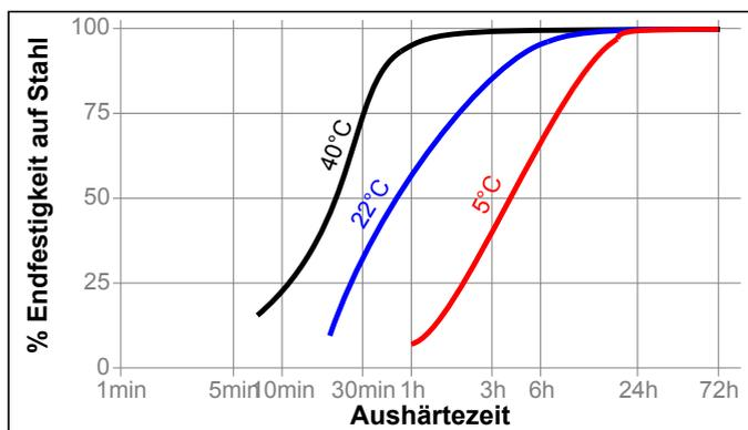
**Aushärtegeschwindigkeit in Abhängigkeit vom Aktivator**
