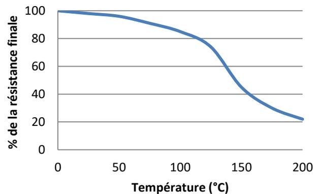
Essais de résistance au cisaillement à des températures élevées sur acier doux. Polymérisation complète à température ambiante, puis mise en température durant 30 minutes avant réalisation des essais.
