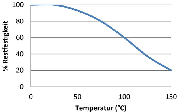
„Hitzebeständigkeit“: Scherfestigkeitsversuche wurden auf Weichstan durchgeföhrt. Aushärtung bei Raumtemperatur vollständig. Vor den Testversuchen wurden die Teile über 30 Minuten auf der Testtemperatur gehalten.
