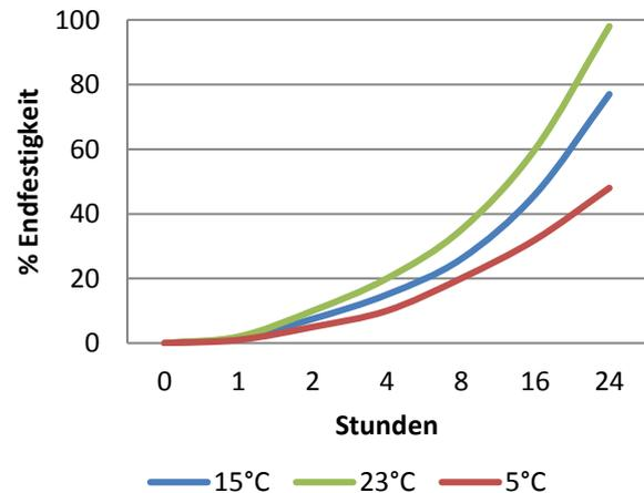
Der Graph zeigt die durchschnittliche Härteentwicklung verklebter Materialien. Eine höhere Temperatur während der Aushärtung führt zu einer schnelleren Aushärtung, bei niedrigeren Temperaturen dauert die Aushärtung etwas länger, jedoch ist der Unterschied deutlich geringer als bei anderen Epoxidharzen.
