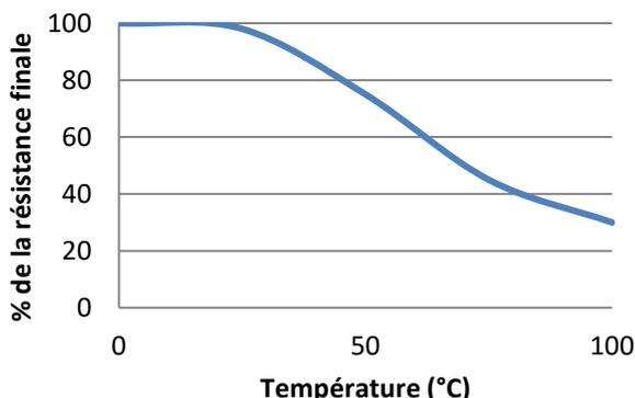
Polymérisation complète à température ambiante, puis mise en température durant 30 minutes avant réalisation des essais.
