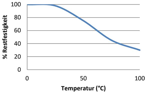
Vollständig ausgehärtete Testteile wurden vor den „Hitzebeständigen“ Scherfestigkeitsversuchen über 30 Minuten auf der Testtemperatur gehalten. TA4630 kann bei geringen Belastungen kurzzeitig auch höheren Temperaturen ausgesetzt werden (z.B. bei Einbrennlack- oder Schwall-Löt-Verfahren). Niedrigste Temperatur bei Endfestigkeit: -55°C (abhängig von den verwendeten Materialien).
