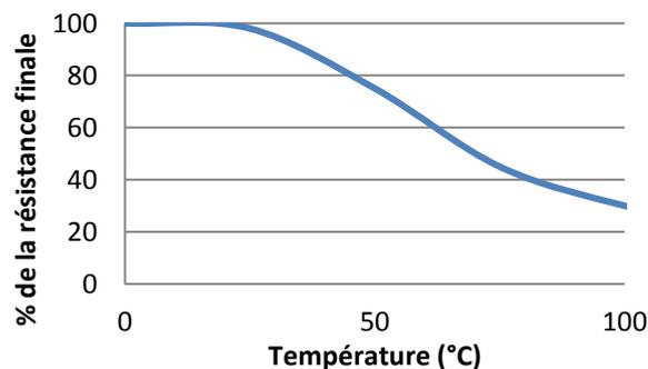
Essais de cisaillement en température réalisés sur acier doux. Polymérisation complète à température ambiante, puis mise en température durant 30 minutes avant réalisation des essais.
