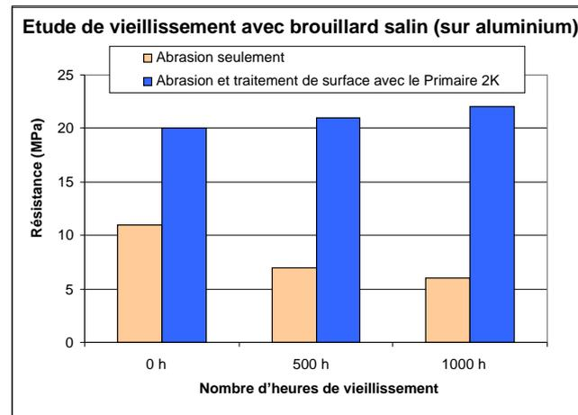
Le graphique ci-dessus montre comment le primaire Permabond 2K peut améliorer la performance d'une colle acrylique structurale sur une surface en aluminium. Les résultats d'essais de vieillissement avec brouillard salin confirment une augmentation notable de la durée de vie de l'assemblage.
