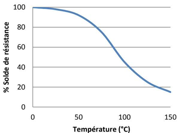
Essais en cisaillement à chaud réalisés sur des assemblages verre sur acier doux. Les échantillons sont entièrement polymérisés avant d'être mis en température pendant 30 minutes avant réalisation des essais. UV630 peut être soumis sous faible contrainte mécanique à des températures plus élevées. Par exemple Thermo-laquage, soudage. Température minimale après polymérisation: -55°C (-65°F) dépendant des matériaux.
