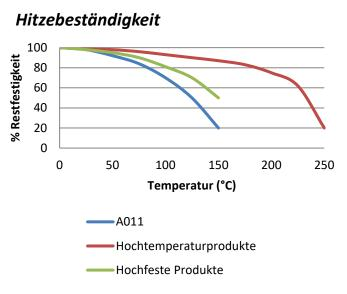
"Hitzebeständige" Losbrechfestigkeit wurde bei verzinkten Schrauben M10 gemäß ISO 10964 geprüft. Aushärtung bei 23ºC über 24 Stunden. Vor den Testversuchen wurden die Teile über 30 Minuten auf der Testtemperatur gehalten.
