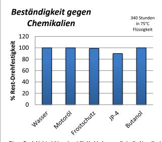
Dieses Produkt ist nicht geeignet für Verbindungen, die in direktem Kontakt mit Dampf oder reinem Sauerstoff stehen. Ein längerer Kontakt mit starken Säuren, Laugen oder stark polaren Lösungsmitteln ist zu vermeiden. Warnung: Das Produkt könnte u.U. einige Thermoplaste angreifen. Dem Anwender wird daher empfohlen, vor Gebrauch eine entsprechende Verträglichkeitsprüfung durchzuführen.
