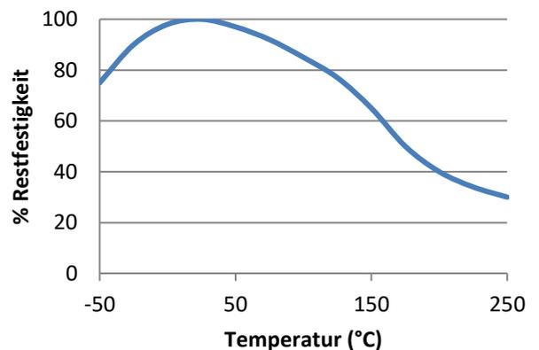
„Hitzebeständige“ Scherfestigkeitsversuche wurden auf Weichstahl durchgeführt. Aushärtung zunächst bei Raumtemperatur, anschließend thermische Nachhärtung bei 150°C über 2 Stunden. Vor den Testversuchen wurden die Teile über 30 Minuten auf der Testtemperatur gehalten.
