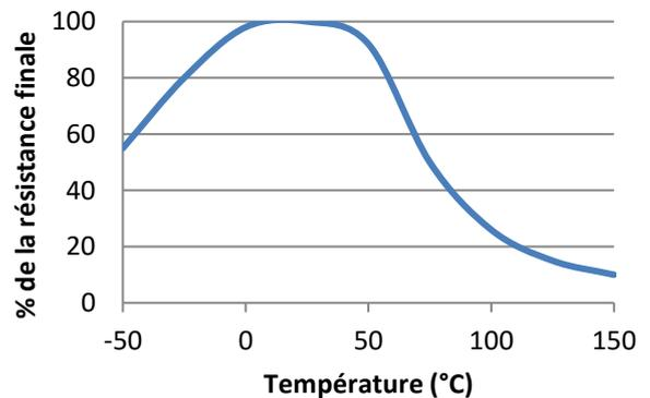
Tests de résistance au cisaillement à des températures élevées sur acier doux. Polymérisation complète à température ambiante, puis mise en température durant 30 minutes avant réalisation des essais.
