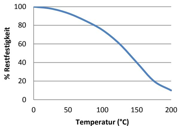
„Hitzebeständige“ Scherfestigkeitsversuche wurden auf Glas auf Weichstahl Klebeverbindungen durchgeführt. Vor den Testversuchen wurden die Teile über 30 Minuten auf der Testtemperatur gehalten. UV7141 kann bei geringen Belastungen kurzzeitig auch höheren Temperaturen ausgesetzt werden (z.B. bei Einbrennlack- oder Schwall-Löt-Verfahren). Niedrigste Temperatur bei Endfestigkeit: -55°C (abhängig von den verwendeten Materialien).
