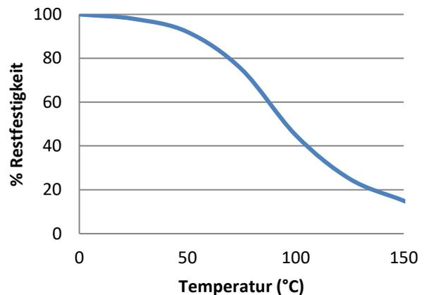
„Hitzebeständige“ Scherfestigkeitsversuche wurden auf Glas auf Weichstahl Klebeverbindungen durchgeführt. Vor den Testversuchen wurden die Teile über 30 Minuten auf der Testtemperatur gehalten. UV645 kann bei geringen Belastungen kurzzeitig auch höheren Temperaturen ausgesetzt werden (z.B. bei Einbrennlack- oder Schwall-Löt-Verfahren). Niedrigste Temperatur bei Endfestigkeit: -55°C (abhängig von den verwendeten Materialien).
