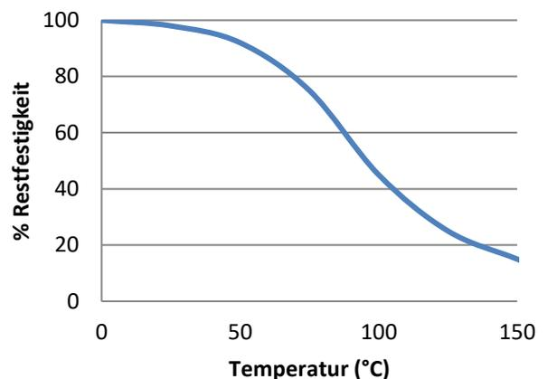
„Hitzebeständige“ Scherfestigkeitsversuche wurden auf Glas auf Weichstahl Klebeverbindungen durchgeführt. Vor den Testversuchen wurden die Teile über 30 Minuten auf der Testtemperatur gehalten. UV639 kann bei geringen Belastungen kurzzeitig auch höheren Temperaturen ausgesetzt werden (z.B. bei Einbrennlack- oder Schwall-Löt-Verfahren). Niedrigste Temperatur bei Endfestigkeit: -55°C (abhängig von den verwendeten Materialien).
