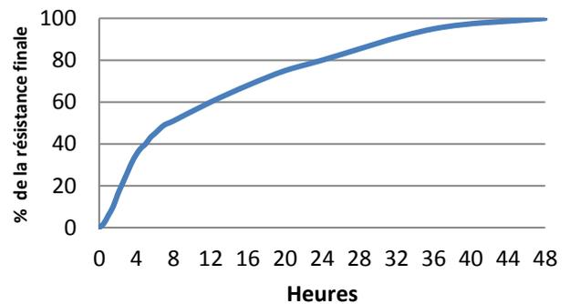
Le graphique ci-dessus montre l'évolution typique de la résistance pour des pièces collées à une température de 23°C. Une température plus élevée ou plus basse risque de changer la vitesse de polymérisation.
