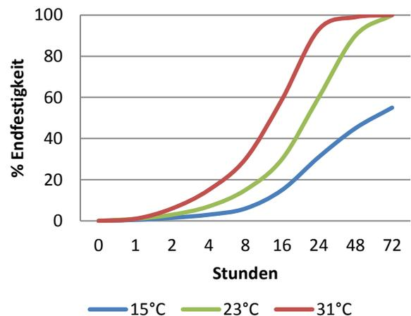
Das Diagramm zeigt den typischen Aufbau der Festigkeit bei der Verklebung von Probestücken. Wird die Temperatur um 8°C erhöht, halbiert sich die Aushärtezeit. Niedrigere Temperaturen haben eine langsamere Aushärtung zur Folge.
