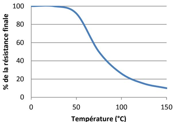
Tests de résistance au cisaillement à des températures élevées sur acier doux. Polymérisation complète à température ambiante, puis mise en température durant 30 minutes avant réalisation des essais.
