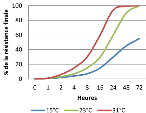
Ce graphique montre un développement typique de la résistance des composants collés. Une augmentation de température de 8° réduira de moitié le temps de polymérisation. Plus les températures sont basses, plus le durcissement est lent.
